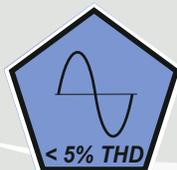
Ce label indique que votre groupe électrogène produit du courant de qualité. (<5% de distorsion harmonique), conçu pour y brancher des appareils électroniques les plus exigeant. (P.e: chargeurs de batteries Li-Ion, meuleuses à démarrage progressif, etc...)
