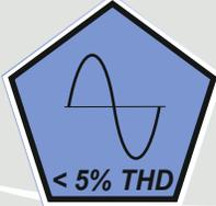
Ce label indique que votre groupe électrogène produit du courant de qualité (<5% de distorsion harmonique), conçu pour y brancher des appareils électroniques des plus exigeants.
