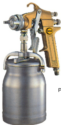
AS-1040-1,8 Pistolet de peinture 1,8mm 1000ml 280L/min, 3,5-5bar
